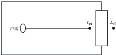
图 4-1 室内声源等效为室外声源图例
